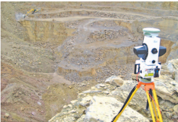
Abb. 1: Laserscanner im Tagebaueinsatz
